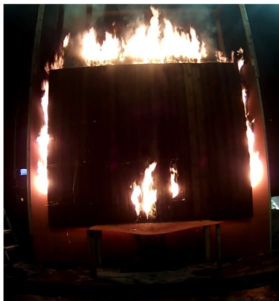
Figur 4-13: Forsøk E4 F-R med brannklasse F som vindsperre og royaloljebehandla furu som kledning 16 minutt etter tenning. Her har brannen spreidd seg heilt ned på begge sidene, i tillegg til at det har brent gjennom kledninga. Startbrannen var i gjennomsnitt 41 kW i 714 sekund.
