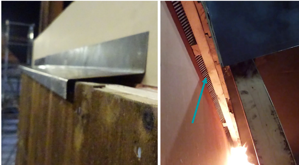
Figur 3-4: (a) Toppbeslag med 5 mm luftespalte brukt i forsøk E8 A2-R, E9 A2-U og E9B A2-U. (b) Museband (vist med pil) sett nedanfrå i holrommet bak den nedste horisontale lekta i forsøk E6 A2-R, E7 A2-U, E8 A2-R, E9 A2-U og E9B A2-U. Forsøka i forsøksoppsett G var bygd opp med museband og toppbeslag på same måte.
