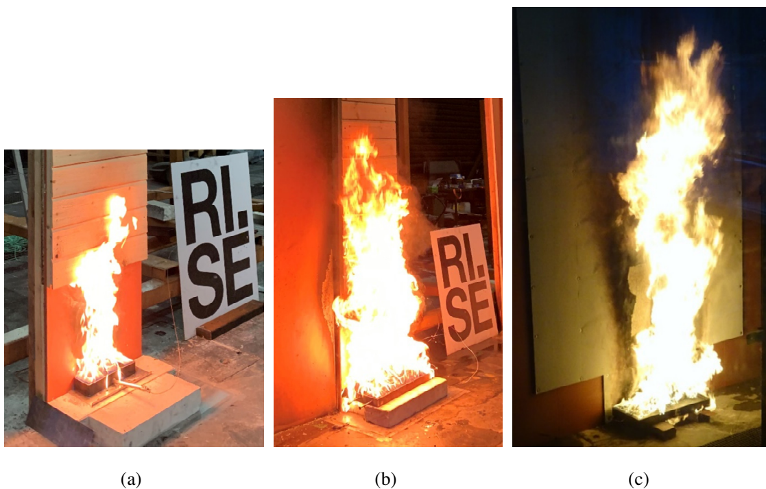
Figur 3-1: Dei tre ulike storleikane av startbrannar som vart brukt, (a): 0,03 m 2 , (b): 0,18 m 2 og (c): 0,5 m 2 .
