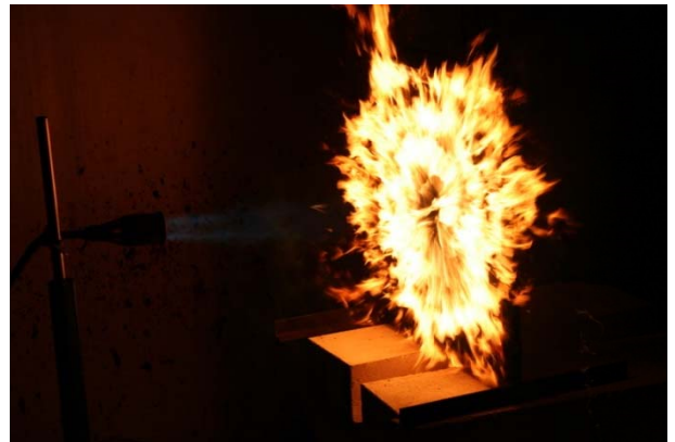
IMO MSC Circ. 1006 Branntest av livbåtslaminat
