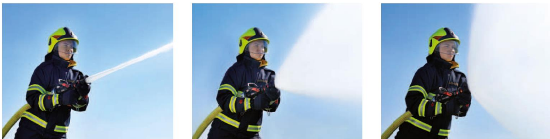
Figur 4-2 Bilde av strålerør med variert spredningsmønster. Til venstre: Kompakt stråle med lang kastelengde. Midten: Vanntåke med middels spredning. Til høyre: Vannskjerm med mange små dråper med stor spredningsvinkel [50].
