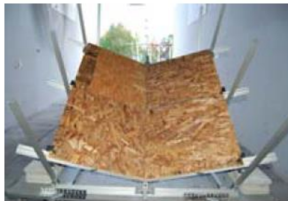
Figur 2-6 Seksjon av OSB-plater til tak, men uten shingel eller tjæreapp. Vinkelen mellom platene ble variert i området 60-135°. Figuren er hentet fra [12].
