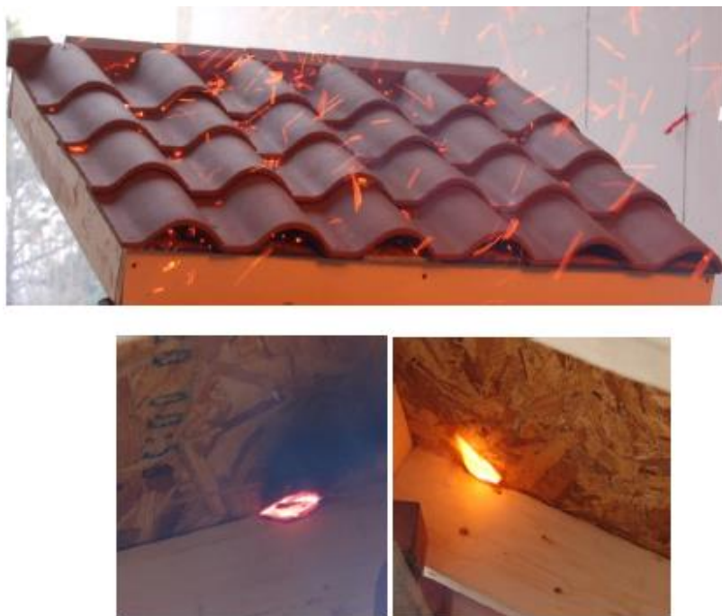
Figur 2-4: Bilder fra forsøk med tak av OSB-plater kledd med tjærepapp og teglstein. Fuglebånd (birdstop) ble ikke benyttet i disse forsøkene. Bildene er hentet fra [10].
