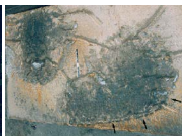
(b) 2 x 3 dl bensin på golvteppe, hvor den nærmeste mengden er lagt som en lunte mot retning til vindtrekken (mot høyre). Full brannutvikling i golvbelegget og sporene etter brannen. Pilene viser til lunta.
