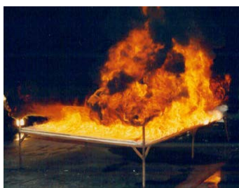
(b) 2 x 3 dl bensin på golvteppe, hvor den nærmeste mengden er lagt som en lunte mot retning til vindtrekken (mot høyre). Full brannutvikling i golvbelegget og sporene etter brannen. Pilene viser til lunta.
