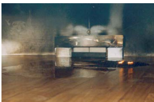
(c) Brannen i white spirit slokner av seg selv etter 55 minutter, uten at all white spirit er brent opp.
