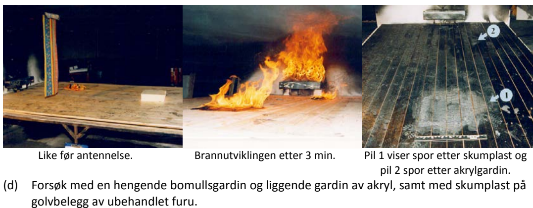
Figur 2.7: Bilder av brannutviklingen i løpet av forsøkene og sporene etter brennbar væske og faste materialer (skumplast og akrylgardin) [5]).
