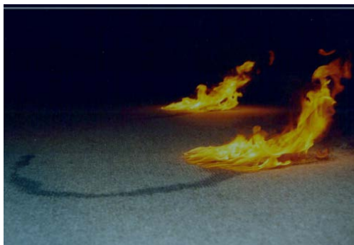
(a) Brannutviklingen etter 90 sekunder ved 2 x 1,5 dl white spirit. Golvteppet etter en brann uten overtenning. Pilene angir retningen på vindtrekken, samt tydelige skillelinjer mellom brente og ikke brente områder
