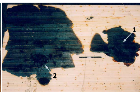
(d) Pil 1 viser området hvor skumplast hadde ligget på furugolv. 2 viser til brannrester etter brann i en hengende akrylgardin som hadde falt ned før overtenning av brannrommet.
