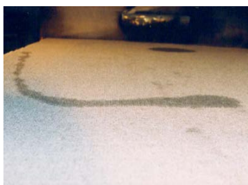
(b) 2 x 3 dl bensin på golvteppe, hvor den nærmeste mengden er lagt som en lunte mot retning til vindtrekken (mot høyre). Full brannutvikling i golvbelegget og sporene etter brannen. Pilene viser til lunta.
