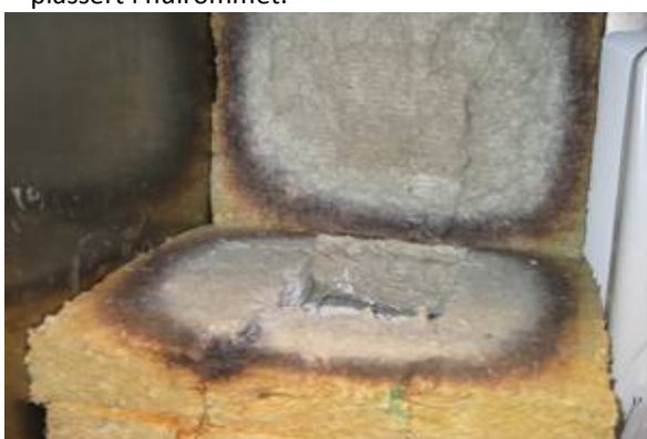
c) Brannskadene i Rockwool-matten.
