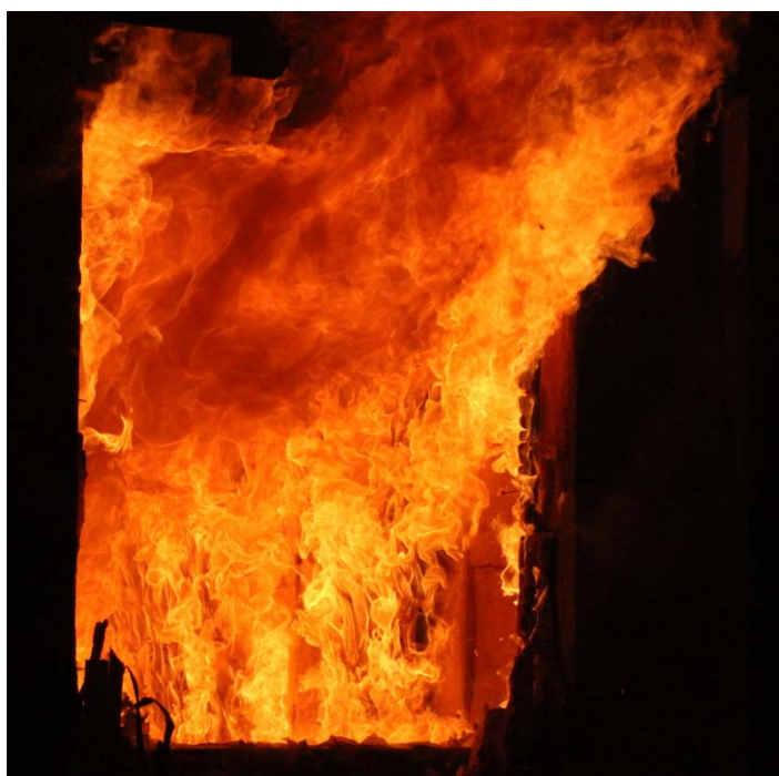
Figur A. 5 Figuren viser den eksponerte massivtreveggen før taket kollapse der man tydelig ser partier som er brent helt gjennom.
