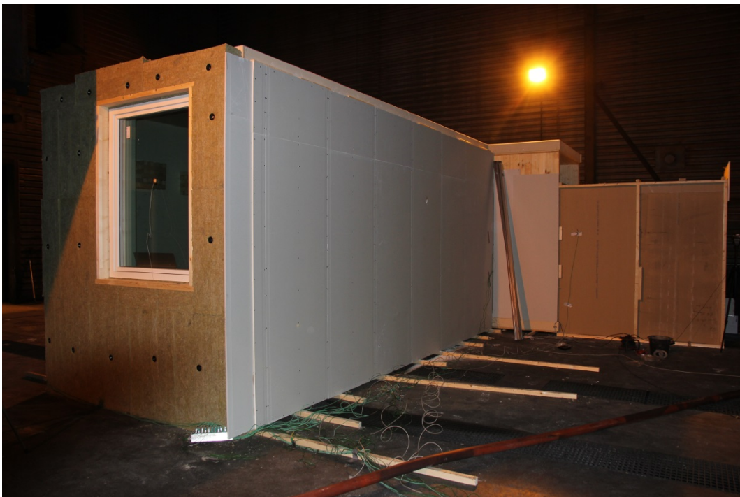
Figur A. 2 Oversikt over hybel og korridor fra utsiden tatt mot den eksponerte veggen (massivtre direkte eksponert på innsiden).
