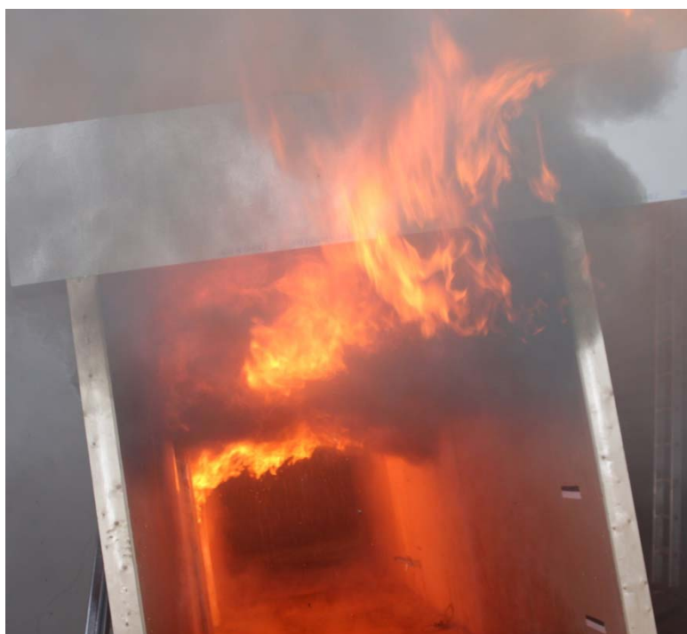
Figur A. 4 Figuren viser brannspredning i og ut av korridoren før himlingen faller ned.
