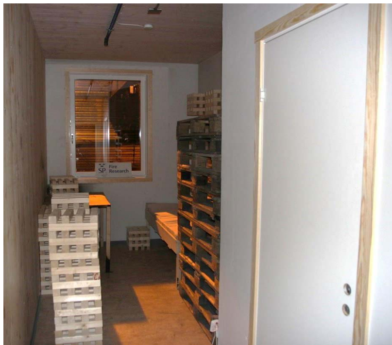
Figur 2.6 Oversikt over plassering av brensel i testen. Brannen startet under pulten i et kar med heptan med en trekrybbe over.
