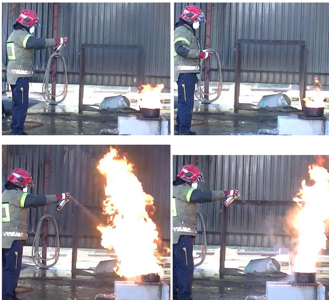
Figur B-4 Flammehøyden økte med en faktor på 4-5 da Elotec Elostop (venstre) og BRANNSTOP (høyre) ble brukt mot en friturebrann. Ingen av de klarte å slokke brannen. Den økte flammehøyden skyldes trolig at slökkemiddelet består av mye vann som fordamper idet det kommer i kontakt med den varme oljen. Når vanndampen forsvinner fra gryta tar det med seg små oljedråper som brenner i luften.
