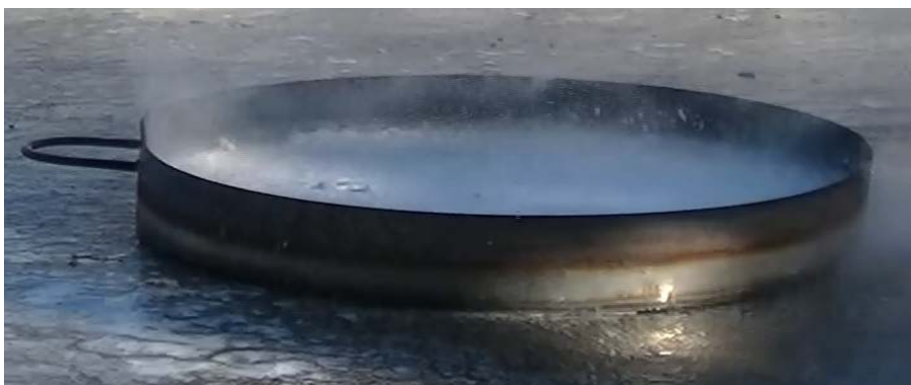
Figur B-3 Brannscenario 21B består av et sirkulært kar med diameter 92 cm. Flere produkter dempet brannen kraftig, men FIRESTOP var det eneste produktet som klarte å slukke brannen i denne testen (2 av 4 forsøk), som vist i bildene over. Bildene er tatt før start (øverst til venstre), etter 9 sekunder (øverst til høyre), etter 12 sekunder (nest nederst) og etter 24 sekunder ( nederst).
