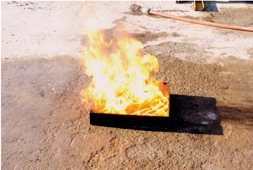
Figur B-2 Brannscenario B middels består av et kvadratisk kar med sidelengde 60 cm.
