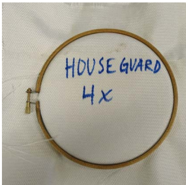
Figur A-2 4 lag med Houseguard-brannteppe innfestet i brodereringen. Overside til høyre, og underside til venstre.
