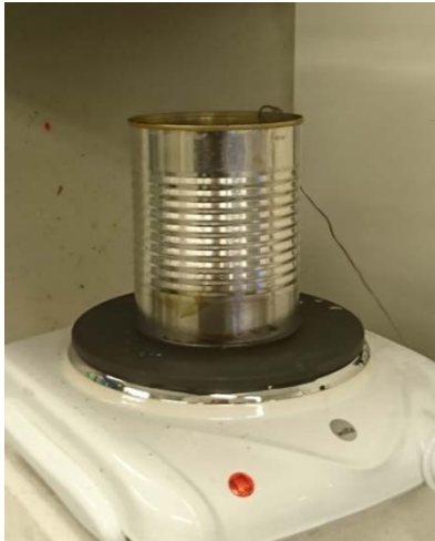
Figur A-1 Oppvarming av olje på kokeplate (venstre). Oljen brenner i boksen (høyre).
