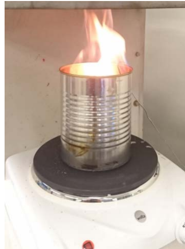
Figur A-1 Oppvarming av olje på kokeplate (venstre). Oljen brenner i boksen (høyre).
