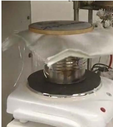
Figur A-3 To lag med brannteppe er nettopp lagt på den brennende boksen.
