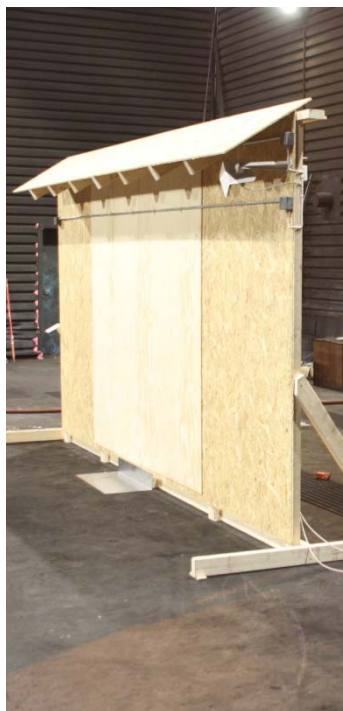
Figur 2-4 Oversikt over testveggen sett fra siden og viser flammedetektoren og plasseringen av de to stålrørene med varmedetekterende kabel.
