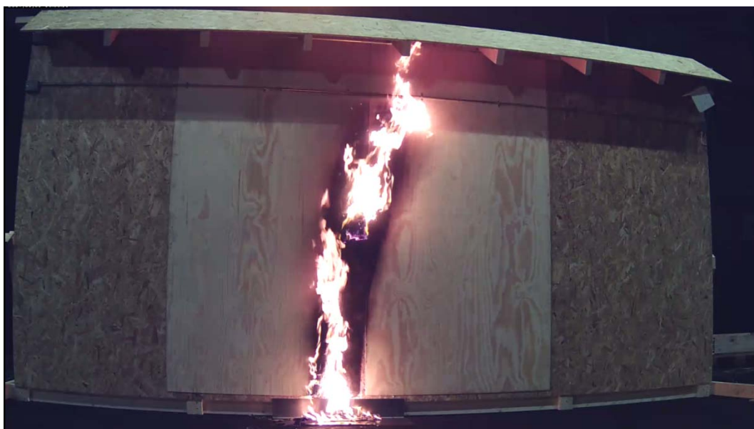
Figur 4-3 Brannbildet idet den øverste varmedetekterende kabelen detekterer brannen, 8 minutter og 20 sekunder etter brannstart.
