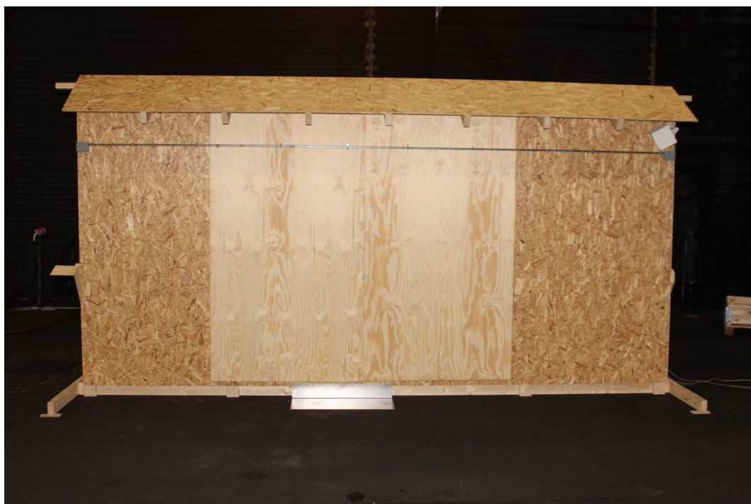
Figur 2-3 Testveggen sett forfra. Flammedektoren sees øverst til høyre og den nederste varmedetekterende kabelen er plassert i stålrøret. Den andre varmedetekterende kabelen er montert under taket.
