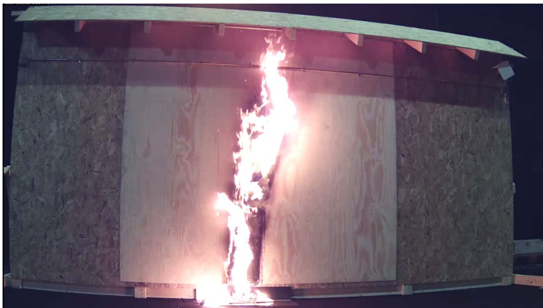
Figur 4-2 Brannbildet idet den nederste varmedetekterende kabelen detekterer brannen, 7 minutter og 55 sekunder etter brannstart.
