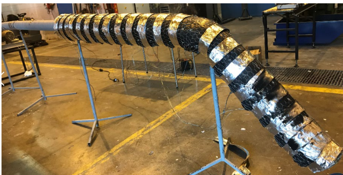
Figur 4-14 Etter at kanalen ble koblet fra ovnen, klarte ikke røret å holde sin egen vekt oppe, og sank sammen. Bildet er fra test 23.
