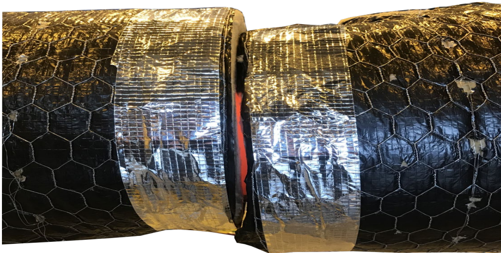
Figur 4-12 Bildet viser at ventilasjonskanalen er rødglødende bak isolasjonen. Kanalen har fått enn liten knekk, som vist ved at to isolasjonsmatter har blitt forskjøvet i forhold til hverandre. Bildet er fra test 22.
