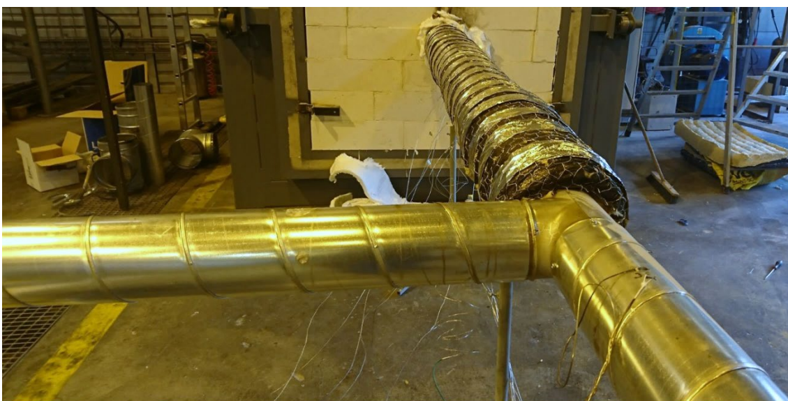
Figur 3-13 Kanal med diameter 125 mm kledd med isolasjon i 2,8 m av rørets lengde, og med innblanding av romtemperert luft der isolasjonen tar slutt. Kanalen er støttet opp med støttebein fra undersiden.
