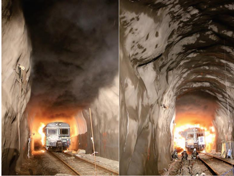
Figur 3-21 Bilder fra branntest i METRO prosjektet. Venstre: Backlayering observert 7 minutter etter antennelse i test 2. To minutter etter dette var ikke lengre toget synlig i røyken. Høyre: 117 minutter etter antennelse i test 3. Foto: Per Rohlén. [6]
