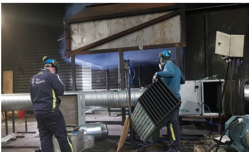
**Figur 4** Filter blir tatt ut av filterkassetten og vekta blir notert undervegs i testen. I bakgrunnen kan ein sjå hetta som samlar opp røyken. (På dette tidspunktet er vifta stoppa for å ta ut filter, røyken blir dermed ikkje samla opp i hetta.)
