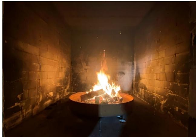
**Figur 5** Bilde av brannrommet med eit bål av oppdelte trepallar.
