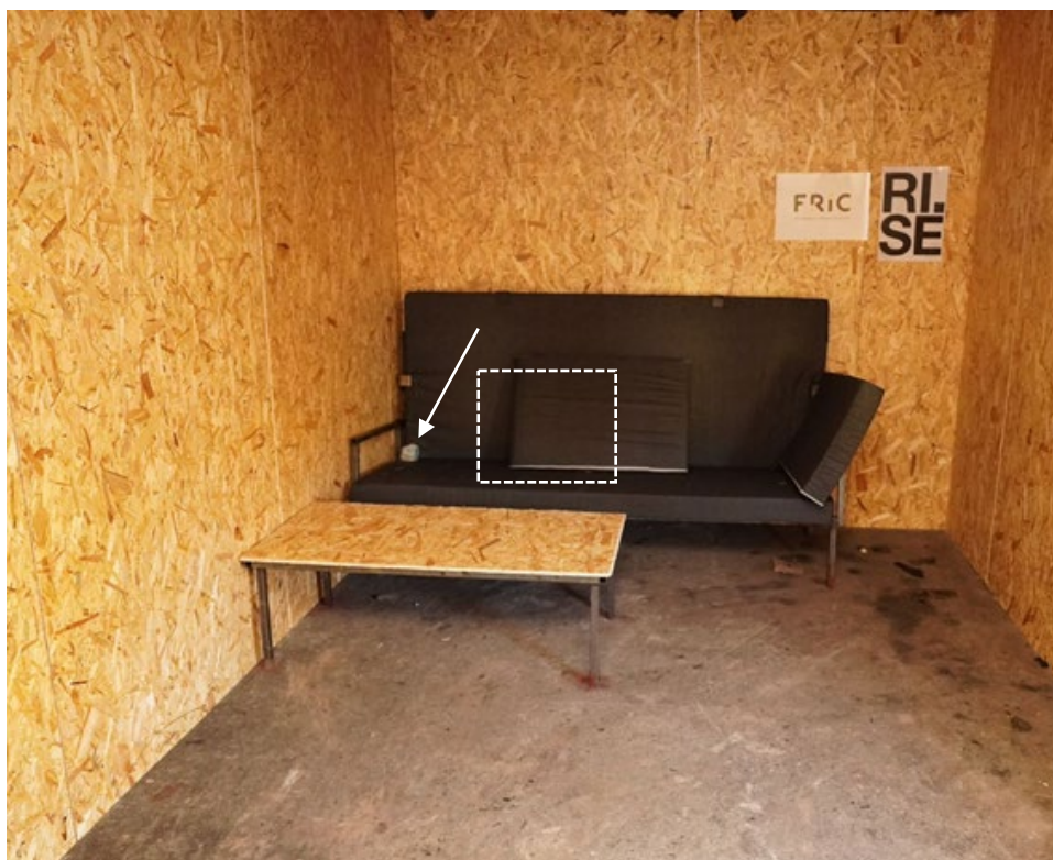
Figur A - 5 Testoppsettet med sofa og bord inne i brannrommet. Til venstre i sofaen er tennkilden (indikert med pil), i senter av sofaen er den ene puten og helt til høyre i sofaen er den andre puten. Stipplet firkant angir bildeutsnitt som er vist i [crossref til neste bilde].
