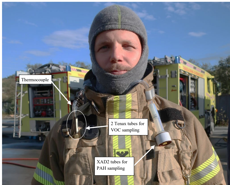
Figur 4-5 Plassering av prøvetakingsutstyr på røykdykker.
