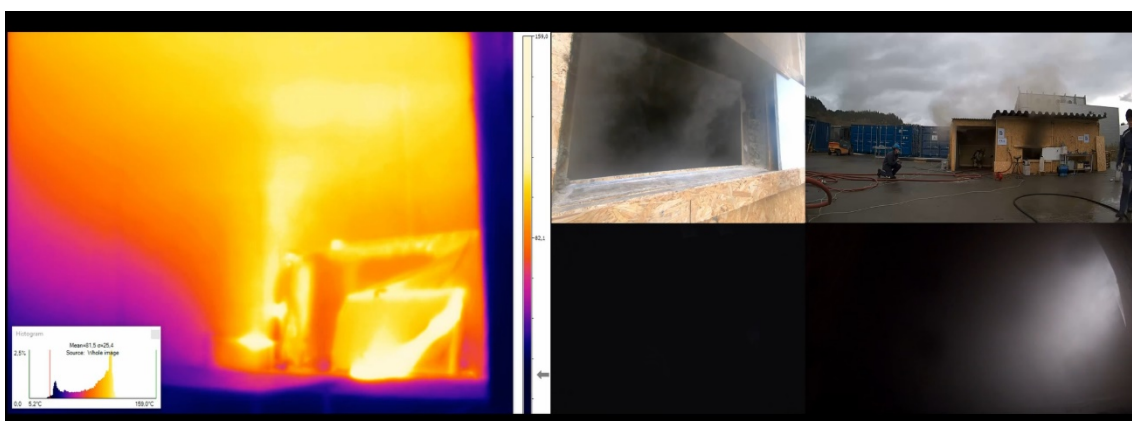
Figur B - 35 Videobilde 3 minutt og 42 sekunder etter tenning. Brannfolk oppholder seg i rommet. Døren er lokket. Brannfolk melder om glødebrann i sofaen; ingen flammer er synlige.
