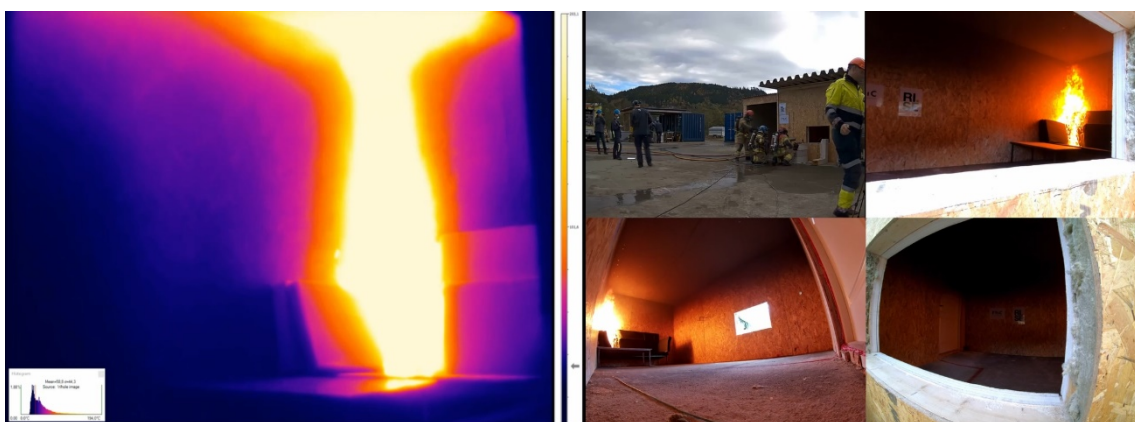
Figur B - 2 Videobilde 1 minutt etter tenning. Flammene når til taket og røksjikt når nesten dørhåndtaket.
