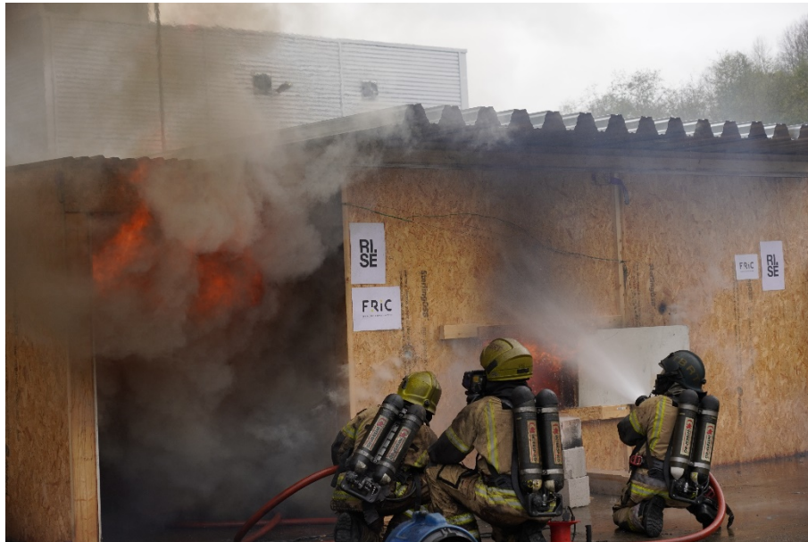
Figur 5-45 Utvendig slokking med strålerør under forsøk F7.
