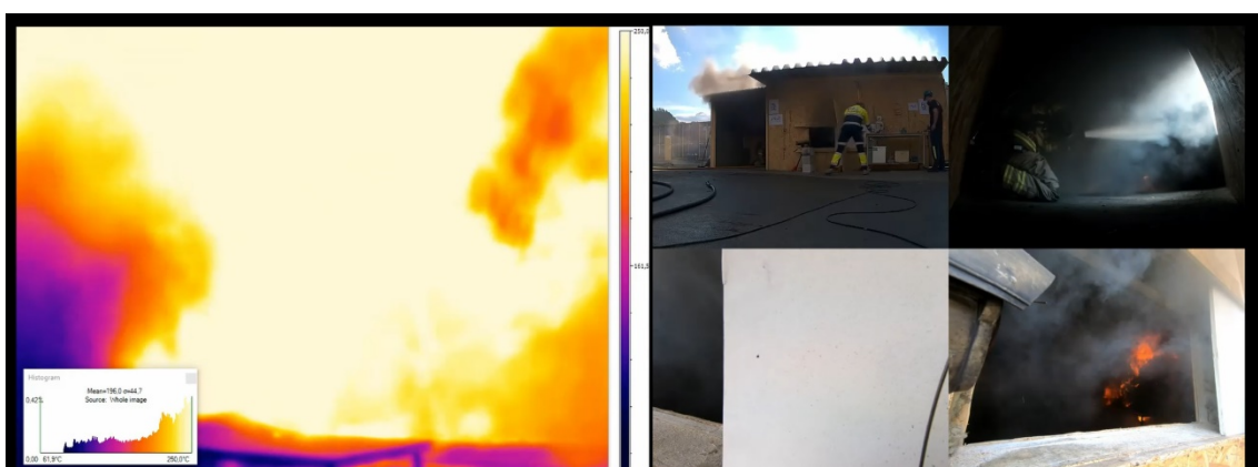
Figur B - 20 Videobilde 2 minutt og 3 sekunder etter tenning. Brannen slokkes indirekte med strålerør og vann. Vannstråle vises i video bildet. Flammene er allerede sterk redusert.
