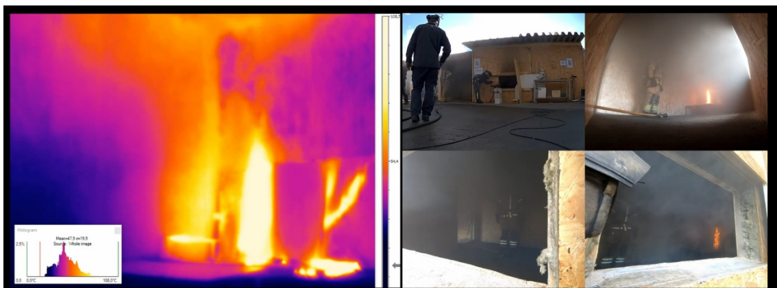
Figur B - 22 Videobilde 6 minutt og 2 sekunder etter tenning. Brannen har tatt seg opp igjen etter midd-puten ble satt på høykant nærmere tennkilden.
