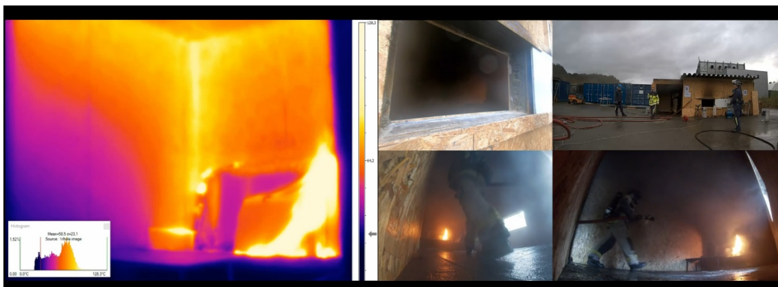
Figur B - 37 Videobilde 6 minutt og 59 sekunder etter tenning. Brannen har tatt seg opp og blir slokket direkte med strålerør.
