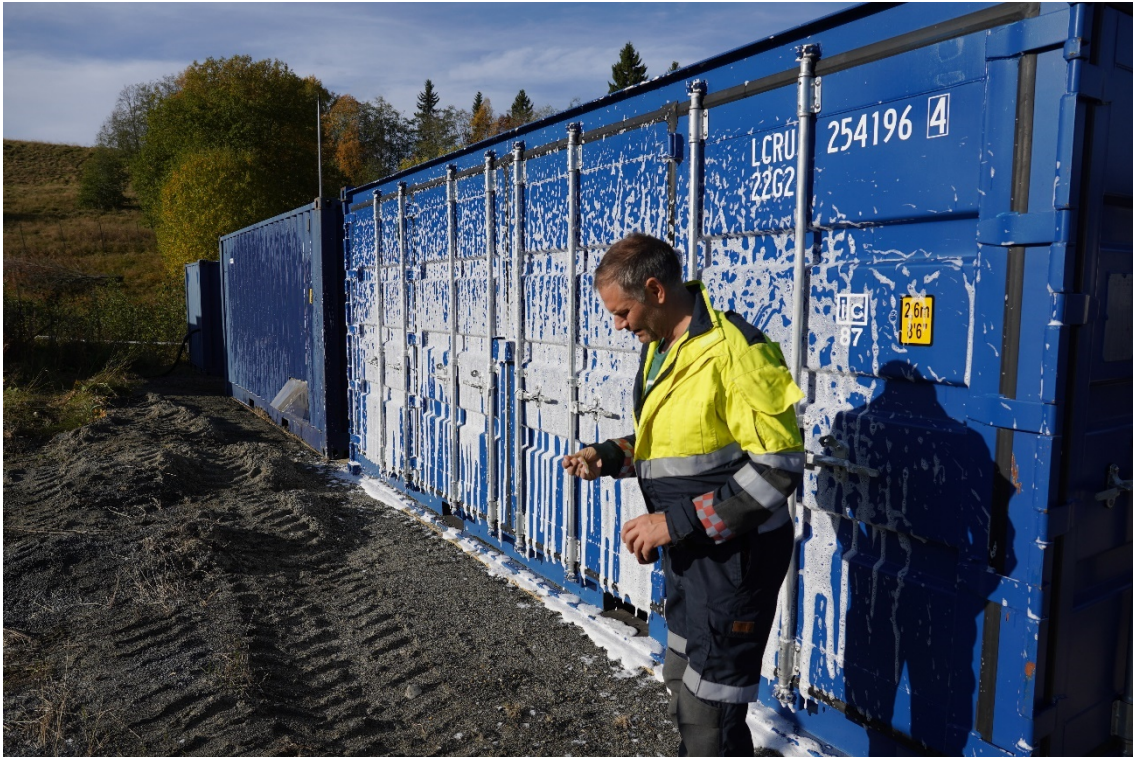
Figur 5-20 Skum med et blandingsforhold av 3% på sideveggen av en kontainer.
