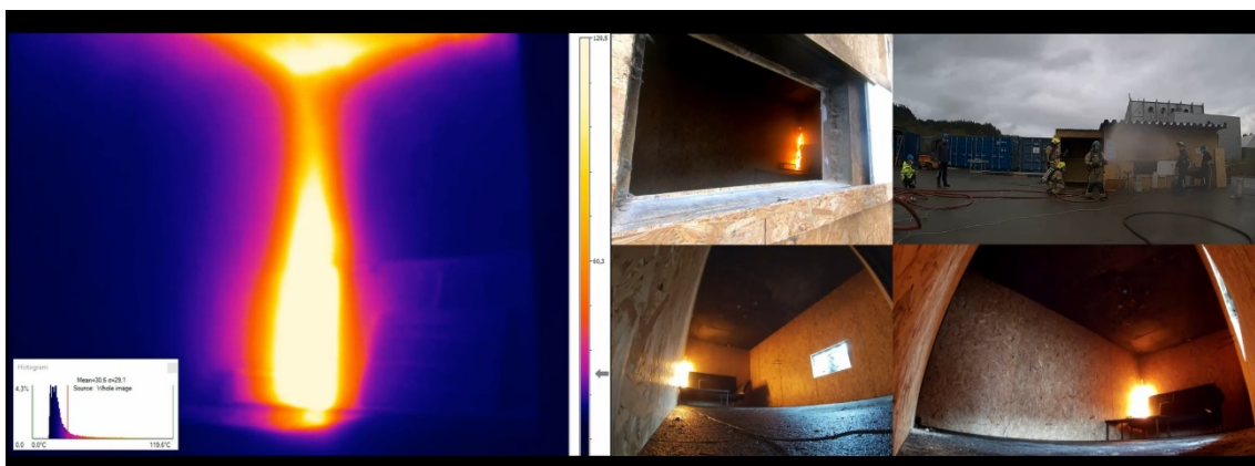
Figur B - 31 Videobilde 54 sekunder etter tenning. Strålerør brukes utenfor rommet.
