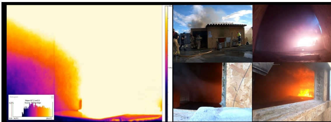
Figur B - 16 Videobilde 6 minutt og 9 sekunder etter tenning. Slik ser brannen ut kort før den blir slokket direkte med strålerør og vann.
