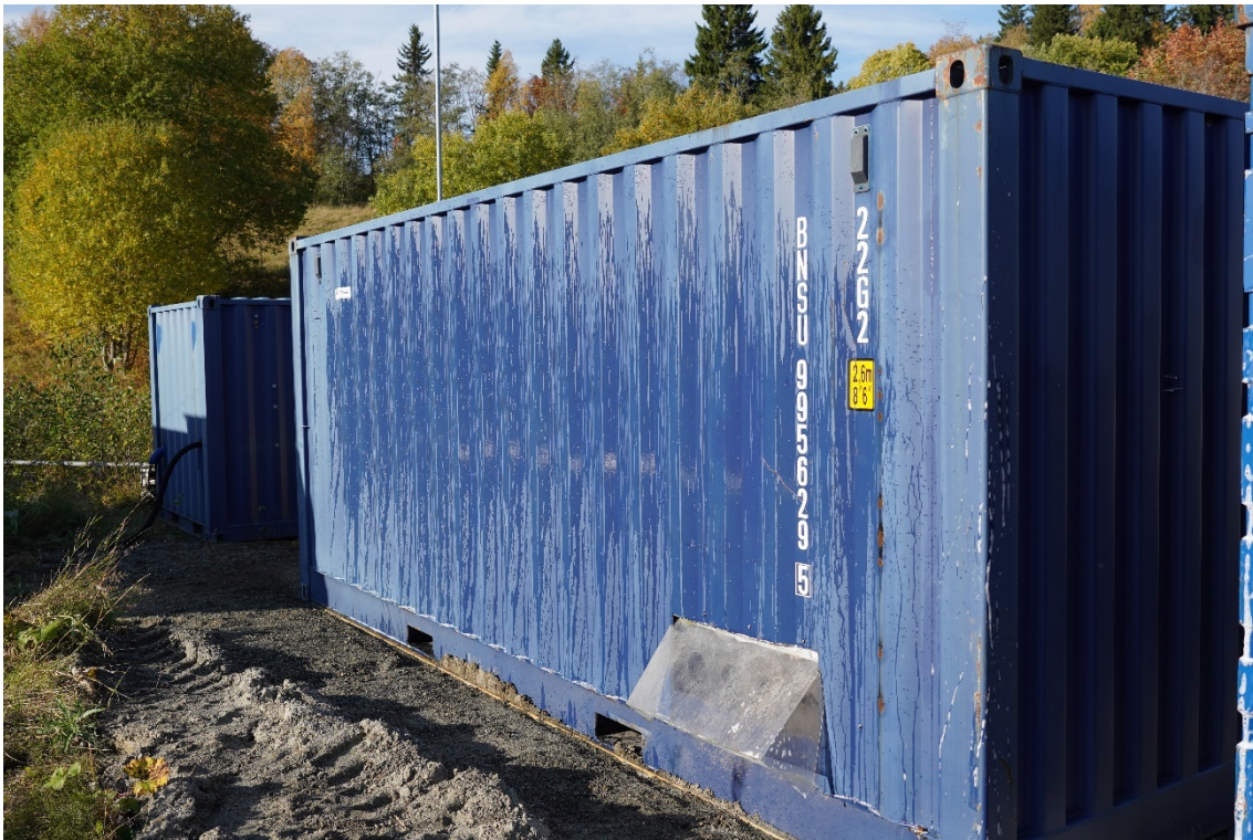
Figur 5-19 Skum med et blandingsforhold av 0.3% på sideveggen av en kontainer. Som bildet viser, gir slike lave konsentrasjoner ikke synlig skum, men brukes som wetting agent .
