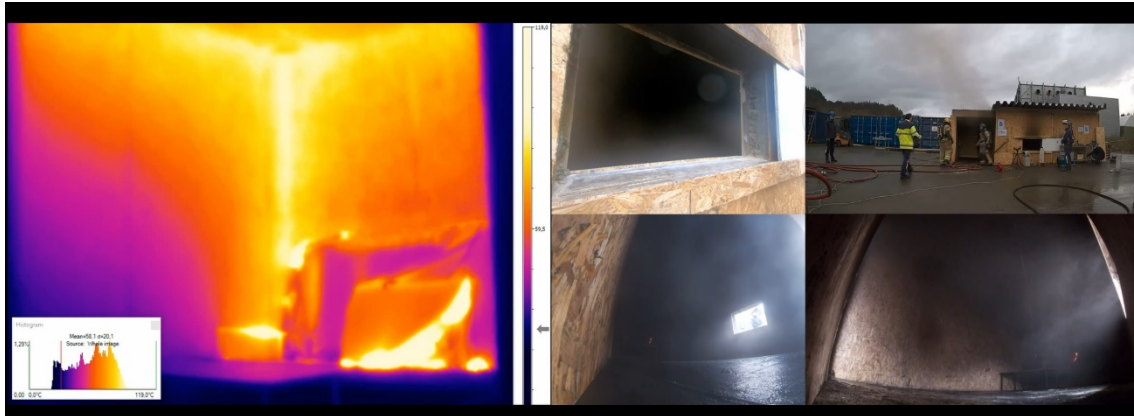
Figur B - 36 Videobilde 6 minutt og 29 sekunder etter tenning. Gjentenning av midtputen og flammebrann er synlig.
