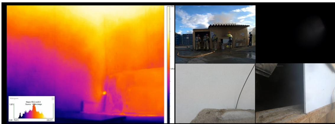
Figur B - 13 Videobilde 2 minutt og 18 sekunder etter tenning. Slokking med skjærslokker stopper.
