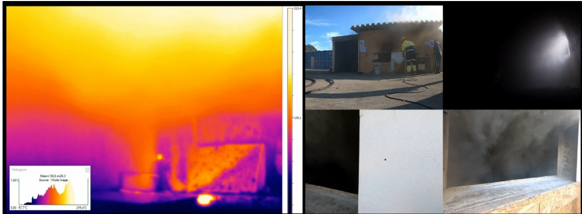
Figur B - 27 Videobilde 2 minutt og 08 sekunder etter tenning. IR bildet av den nedre madrassen viser på denne tidspunkt lokalt fortsatt temperaturer over 200°C etter slokkingen ble stoppet.
