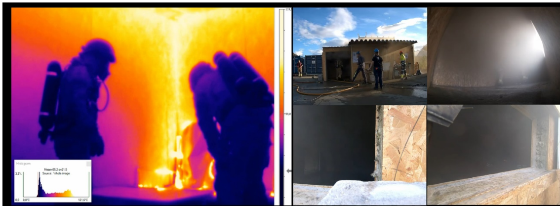
Figur B - 15 Videobilde 5 minutt og 9 sekunder etter tenning. Gjentenning av brannen i nærheten av tennkilden.
