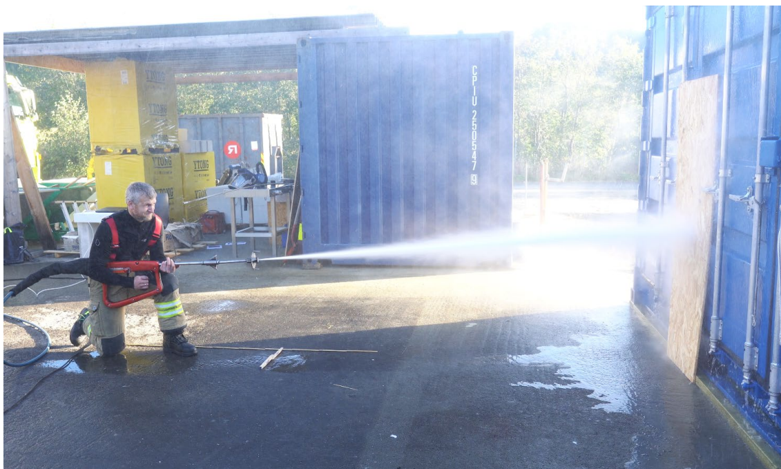
Figur 3-9 Spredning av skjærslokker strålet når den treffer vegg på motsatt siden av rommet. Avstand av skjærslokkeren i dette bildet til OSB-plate tilsvarer samme avstand som rom bredden.
