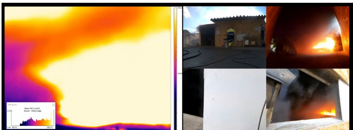
Figur B - 19 Videobilde 2 minutt og 2 sekunder etter tenning. Brannen slokkes indirekte med strålerør og vann. Vannstråle vises i IR bildet.
