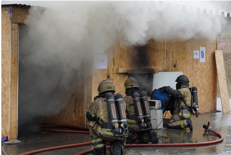
Figur 5-47 Lufttilførsel med vifte etter slokking for å hjelpe brannen til å ta seg opp igjen.
