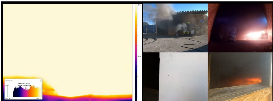
Figur B - 25 Videobilde 1 minutt og 54 sekunder etter tenning. Indirekte slokking med strålerør og skum starter.
