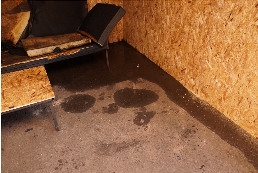
Figur 5-37 Slokkevannrester etter forsøk F3, slokking med strålerør og vann.
