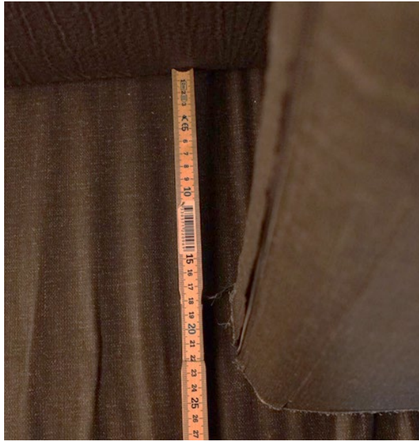
Figur A - 6 Avstand fra bakryggen (den vertikale madrassen) i sofaen og nedre del av madrassbiten som simulerte pute i forsøksoppsettet.
