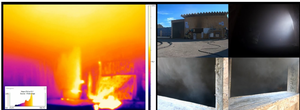
Figur B - 29 Videobilde 3 minutt og 03 sekunder etter tenning. IR bildet viser at temperaturen begynner å stige lokalt igjen.
