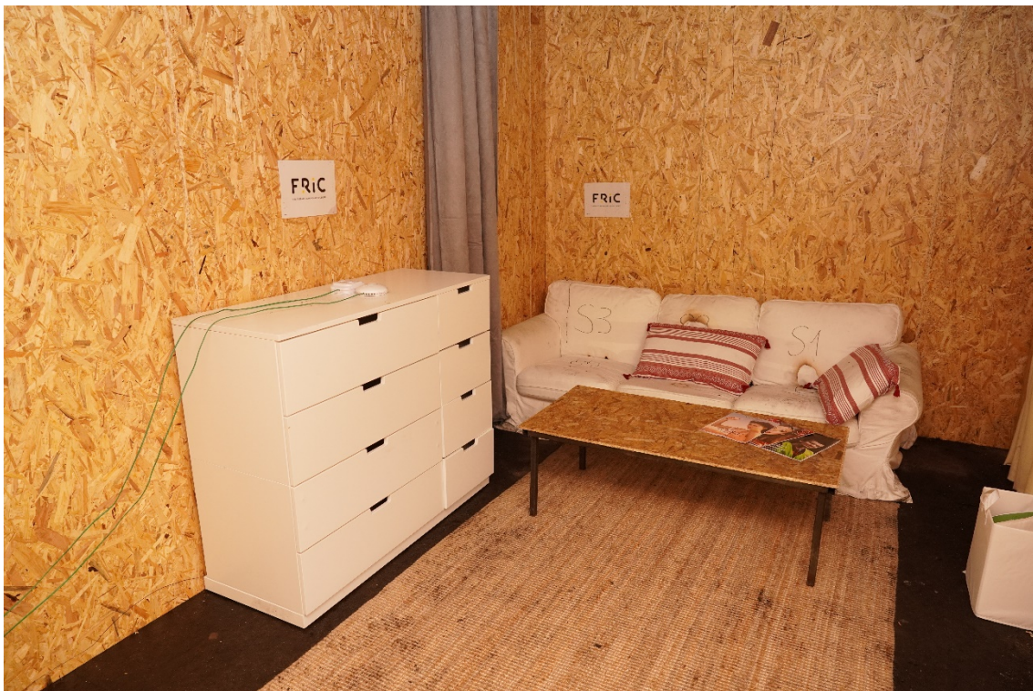
Figur A - 7 Testoppsettet med ekte møbler inne i brannrommet: en kommode, en sofa, to sofaputer, to gardiner, et gulvteppe, tre aviser/magasiner og et bord.
