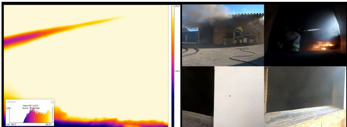
Figur B - 26 Videobilde 1 minutt og 57 sekunder etter tenning. Indirekte slokking med strålerør og skum pågår. Skum/vann strålet vises i IR og video bildet.
