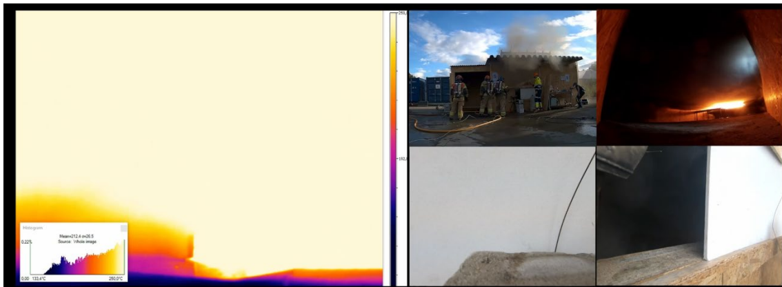
Figur B - 12 Videobilde 2 minutt og 8 sekunder etter tenning. Slokking med skjærslokker starter.
