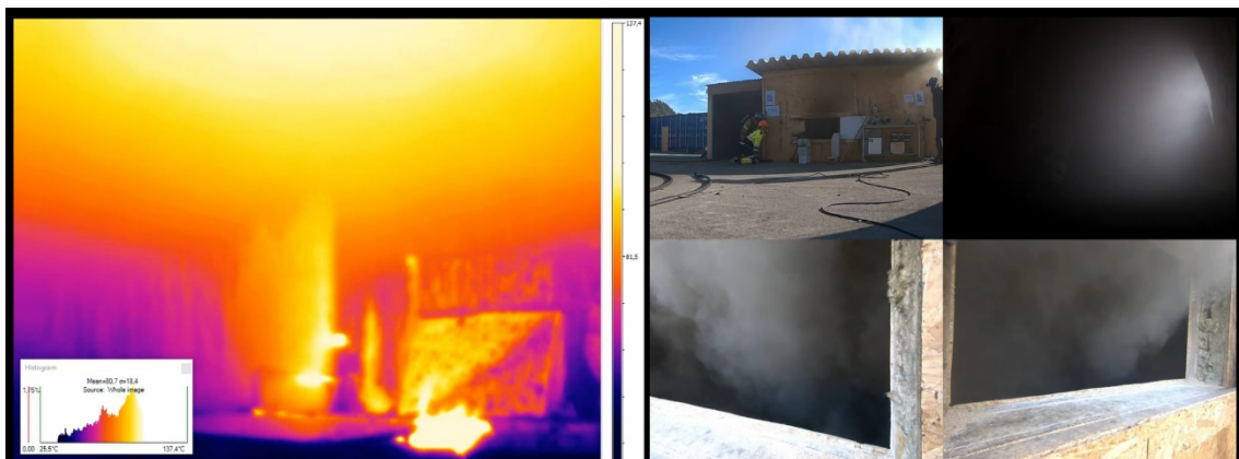
Figur B - 28 Videobilde 2 minutt og 53 sekunder etter tenning. Gjentenning blir observert.
