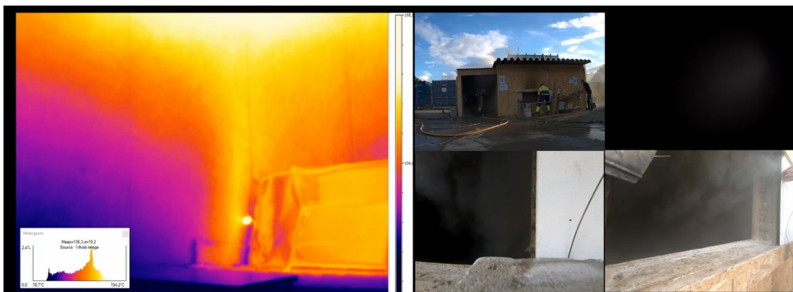
Figur B - 14 Videobilde 2 minutt og 24 sekunder etter tenning. Ventilasjonsåpningen åpnes, samtidig som brannfolk går inn i rommet.
