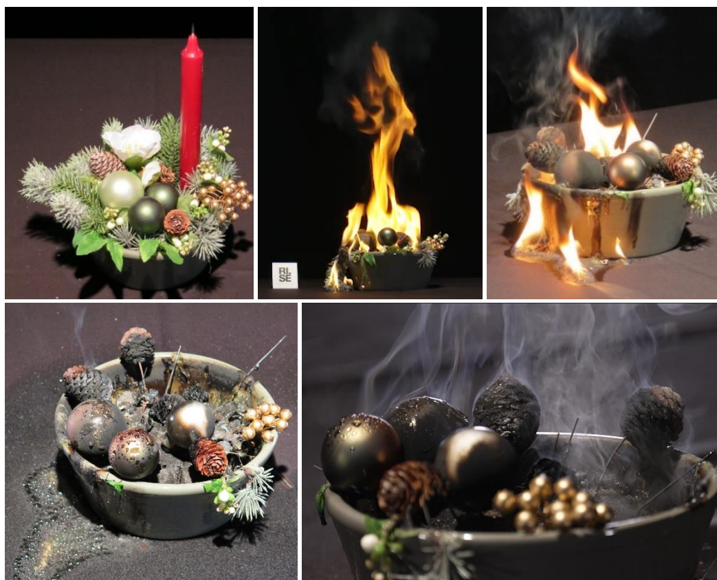
Figur 2-9 Levende lys nær brennbare plastdekorasjoner kan føre til raske og intense brannforløp. Bildet øverst til høyre viser dekorasjonen før tenning av lys. Bildet øverst i midten ble tatt da flammene var på det høyeste. Bildet øverst til høyre viser slutten av forsøket, da brannen i skålen hadde roet seg litt og flammene spredte seg utover duken. Bildene nederst viser dekorasjonen etter den ble sløkket. Foto: RISE Fire Research/Screen Story.
