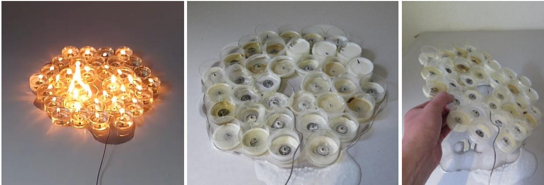
Figur 3-6 Case E (stearin og plastbeger) under og etter forsøket. Flere av plastbegrene smeltet og brennende stearin rant utover.
