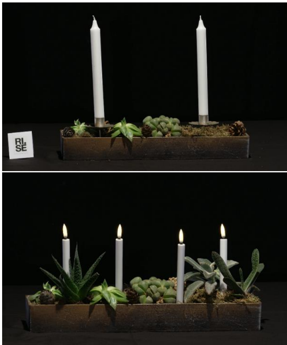
Figur 2-8 Sannsynligheten for at dekorasjonen antennes kan reduseres ved å bruke lysholdere i metall, 10 cm avstand mellom lysene, og unngå at dekorasjoner når høyere enn lysholderen. Et enda bedre alternativ er å bruke LED-lys nær brennbare naturdekorasjoner, som vist i det nederste bildet. Foto: RISE Fire Research/ Screen Story.
