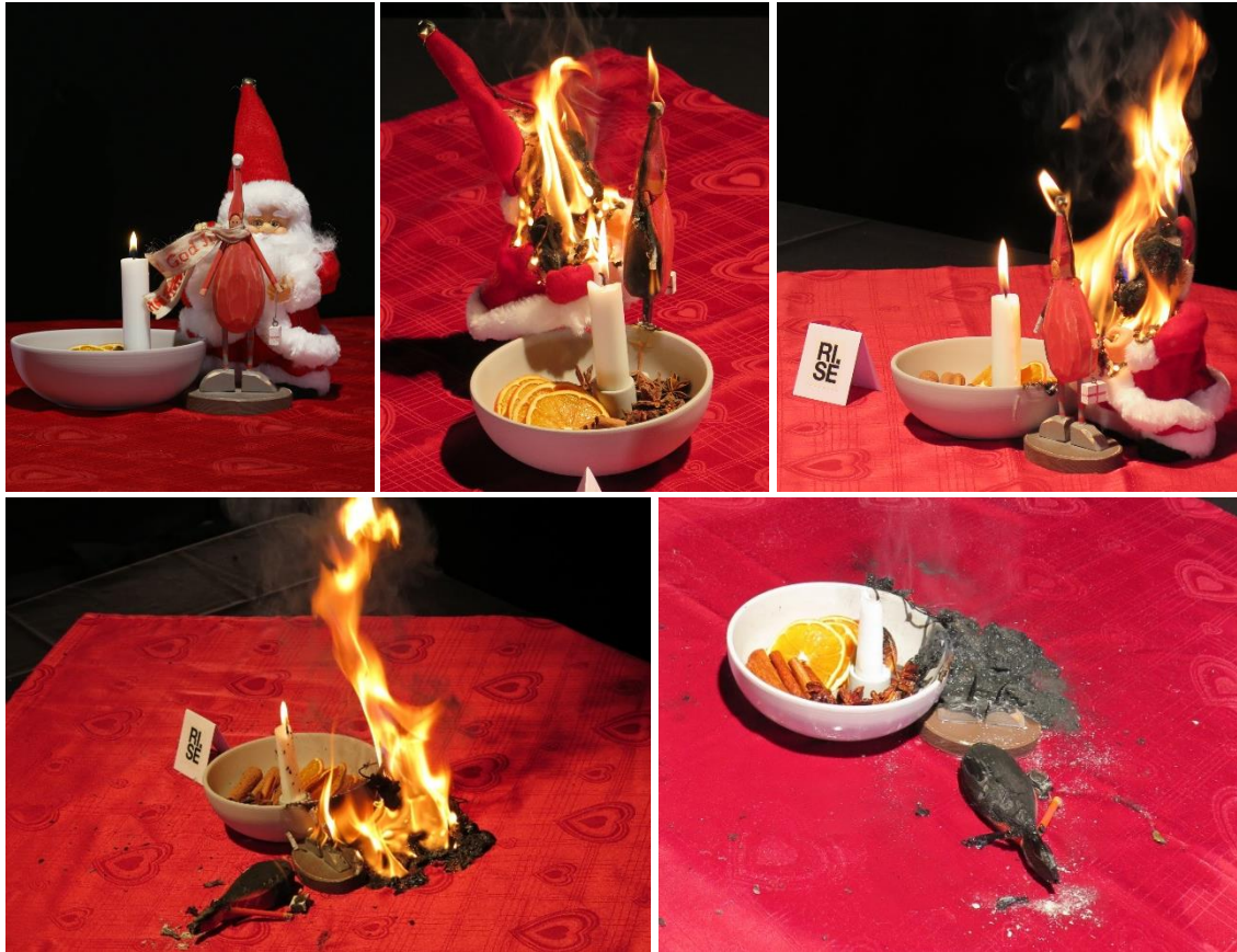
Figur 2-11 Farlige situasjoner kan oppstå når levende lys står nær brennbar julepynt. Denne demonstrasjonen viser også at plast og treverk kan brenne forskjellig. Foto: RISE Fire Research/ Screen Story.
