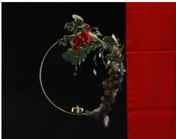
Figur 2-5 Et tryggere alternativ er å bruke telys med god avstand til brennbare naturdekorasjoner. Dette er likevel ikke anbefalt, da det fortsatt kan være en betydelig fare for at dekoren antenner i dette scenariet. Foto: RISE Fire Research/Screen Story.
