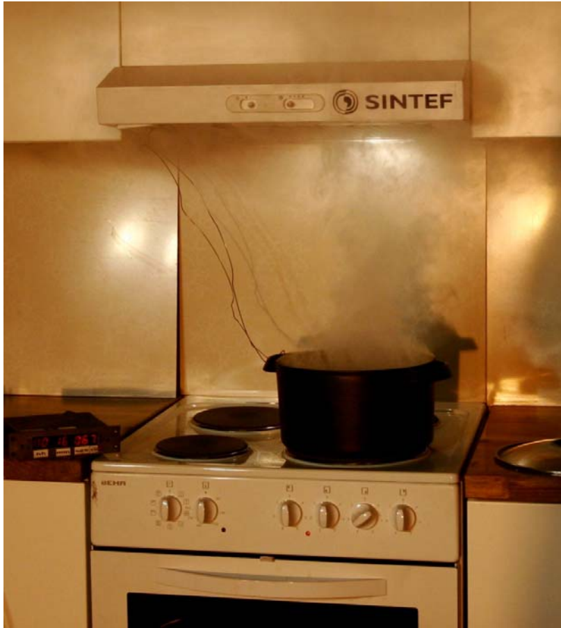
Figur 5-4 Innledende test med støpejernsgryte på komfyr med støpejernsplater.
